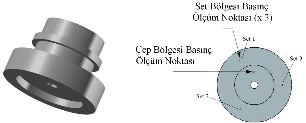
Şekil 4.13. Kayıcı pabuç modeli ve basınç ölçüm konumları
