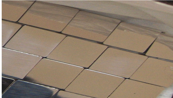
Şekil 3.1. Deneyde kullanılan parlatılmış AISI 304 taban malzemeler
