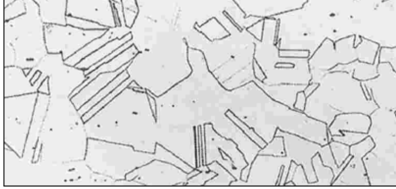
Şekil 2.2. Östenitik çelik mikro yapısı
