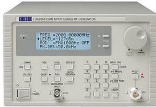
Şekil 2.1. Çalışmada kullanılan radyo frekansı işaret üretici
