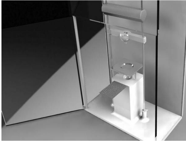
Şekil 3.16. Ağırlık düşürme test düzeneğinin ayrıntılı görünümü
