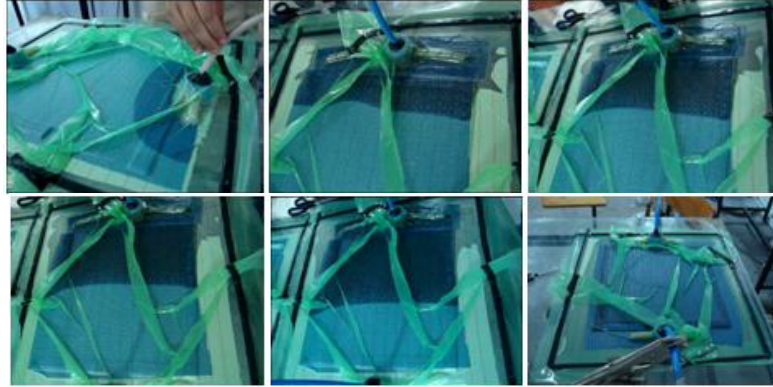
Şekil 2.48. Reçinenin sisteme yayılması.
