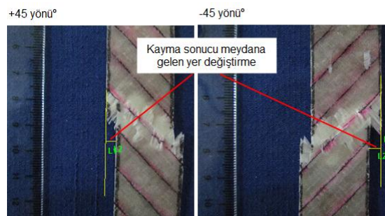
Şekil 2.148. Çekme testi sonrası +45^\circ ve -45^\circ numunelerinde kayma sonucu meydana gelen yer değiştirmenin ölçülmesi.
