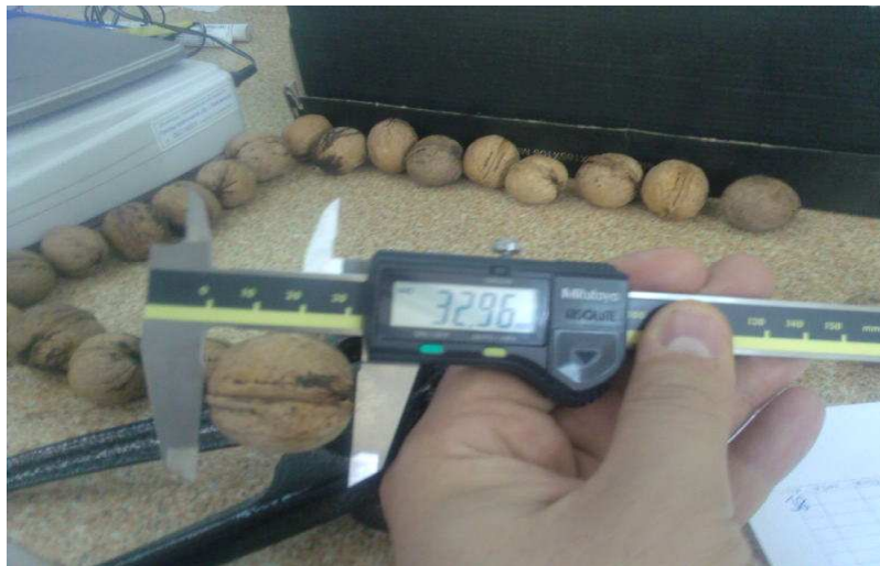
Şekil 2.1. Meyve boyutlarını ölçmede kullanılan dijital kumpas
