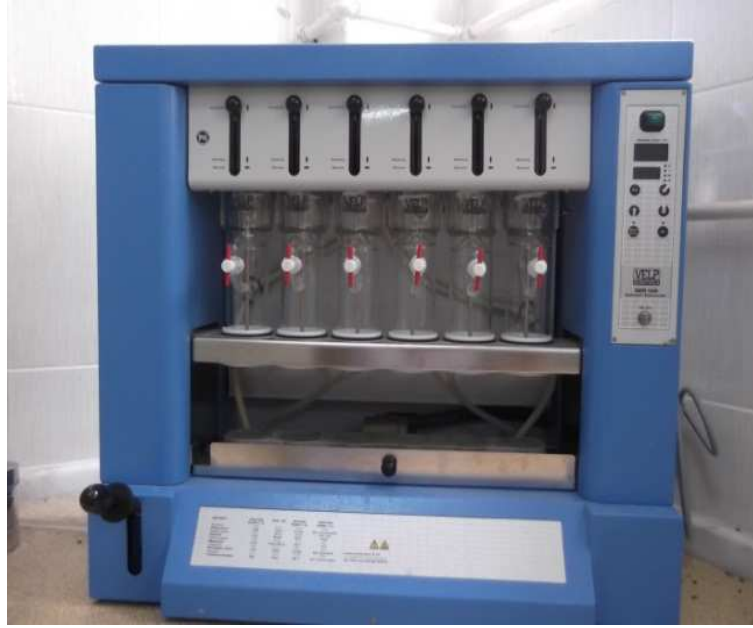
Şekil 2.8. Eter yardımıyla yağın çözünmesini ve ayrışmasını sağlayan cihaz (Velp, Ser 148, Solvent Extractor)
