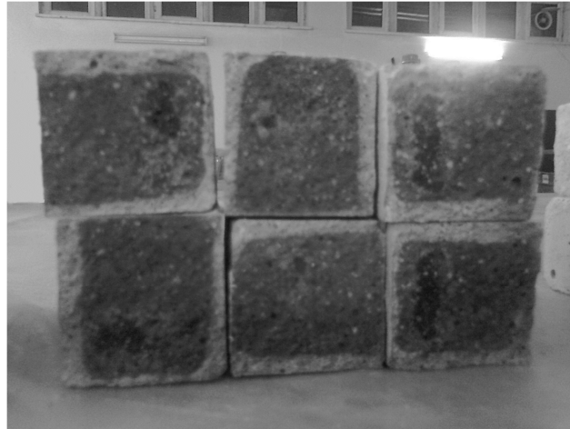
Şekil 3.8. Karbonatlaşma ölçümünde kullanılan harç numuneler
