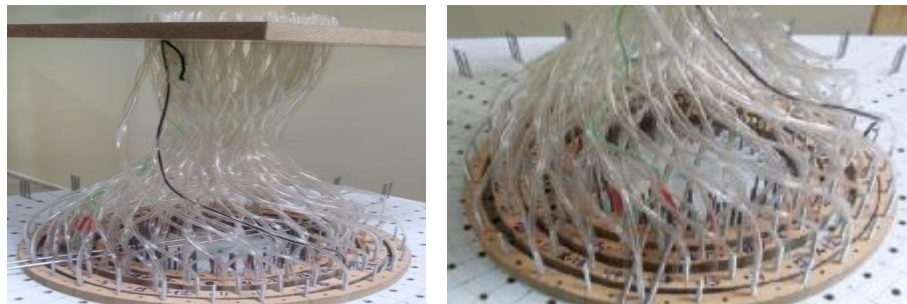
Şekil 2.68. Üç boyutlu (3D) dairesel çözümlü uzantılı Bilişik yöntemli [2kat(3kat)B + 1katA 2x1] önşekil.
