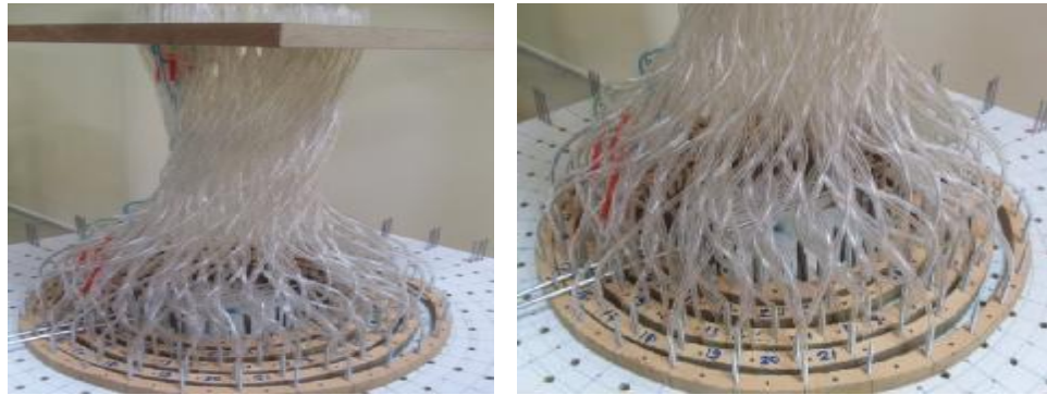
Şekil 2.65. Üç boyutlu (3D) dairesel çözümlü uzantılı Bilişik yöntemli [3kat(4kat)B + 2katA 1x1] önşekil.
