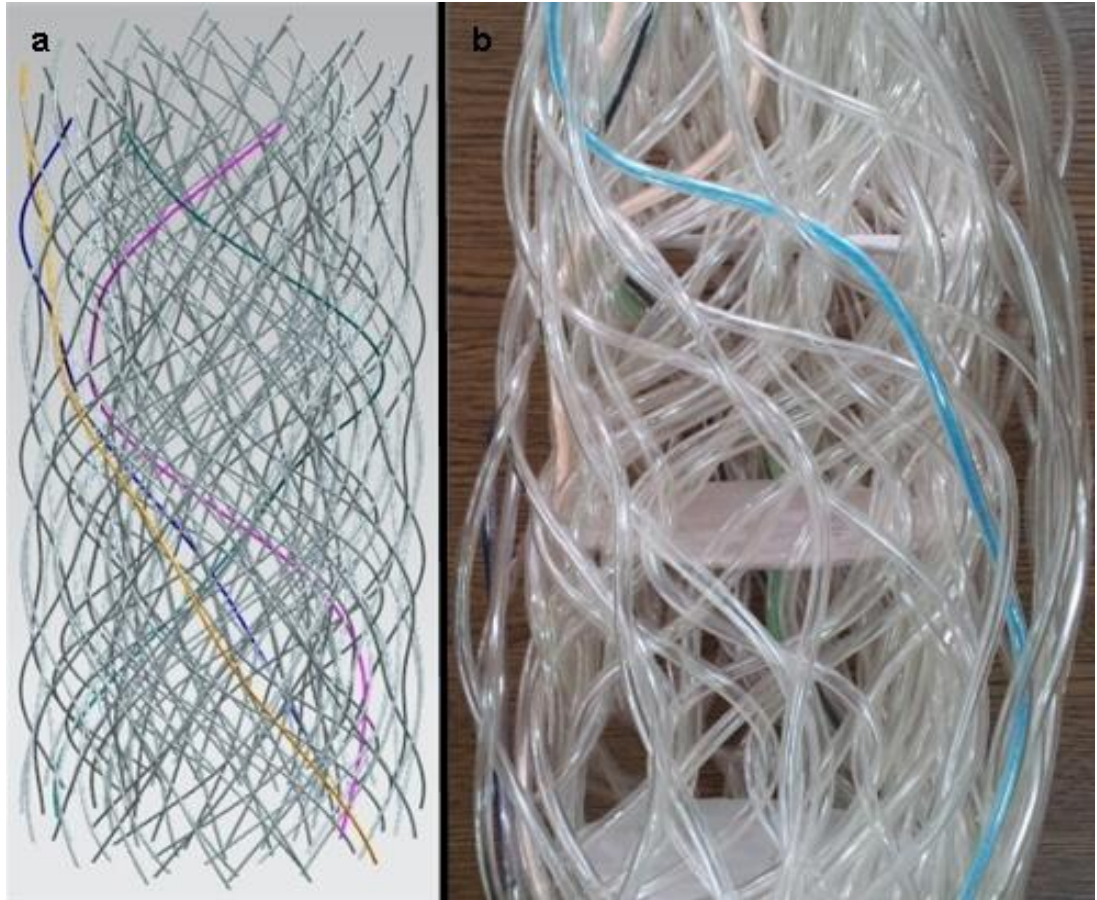
Şekil 3.69. Üç boyutlu (3D) dairesel Bilişik yöntemi [2kat (3kat) 4x1] öñşekilin a) yüzey görüntüsü bilgisayar çizimi b) öñşekil resmi.
