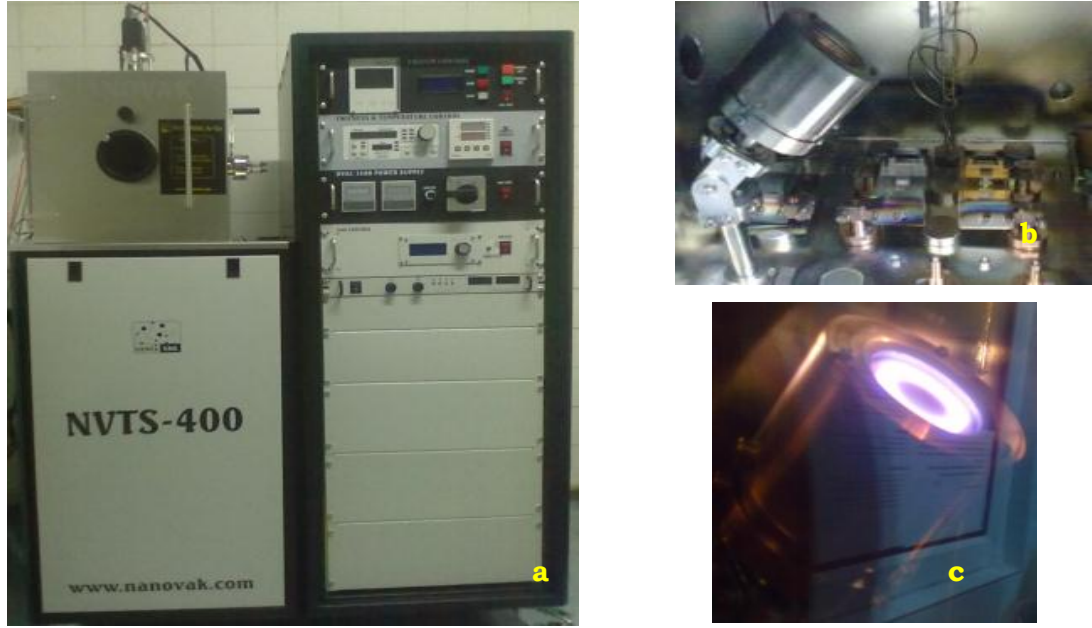
Şekil 2.19. (a) NVTS-400 saçtırma-buharlaştırma sistemi, (b) ısıtıl buharlaştırma hazneleri ve dc manyetik saçtırma kafası, (c) saçtırma sırasında oluşan Ar + plazması.
