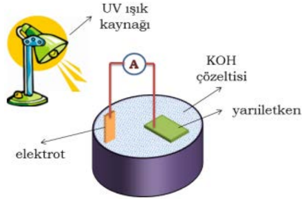
Şekil 2.11. Foto elektrokimyasal (PEC) aşındırma sisteminin şematik gösterimi.
