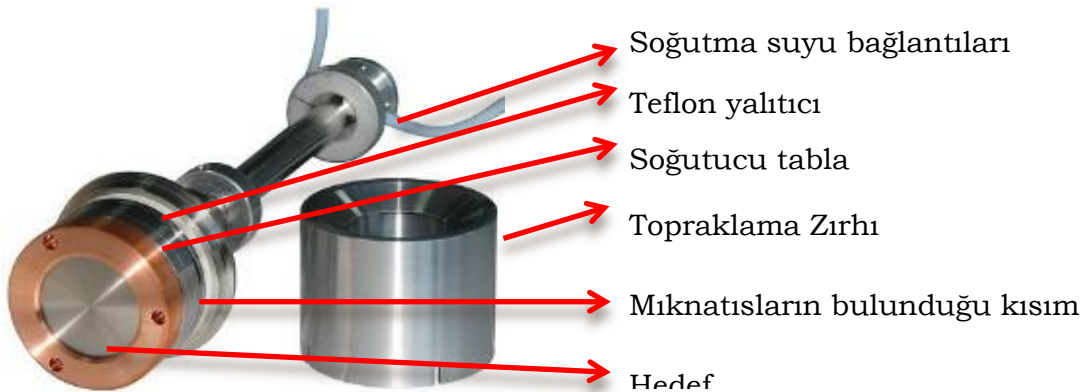
Şekil 2.18. Kurt Lesker firmasına ait Torus 2" dc mıknatıslı saçtırma sistemi.
