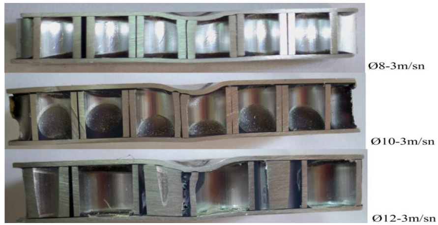
Şekil 4.5. Ø8, Ø10 ve Ø12 mm çapında birim hücreli sadviç kompozitin desteksiz olarak 3m/s hızında vurucu ile darbe testi sonrası numunenin kesiti
