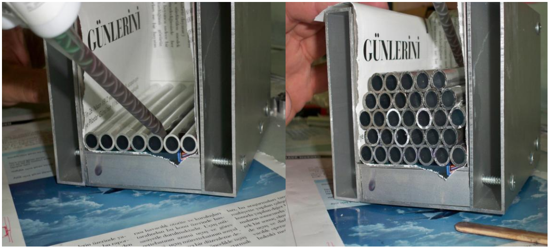
Şekil 3.5. Alüminyum borulara kalıpta yapıştırıcı uygulanması
