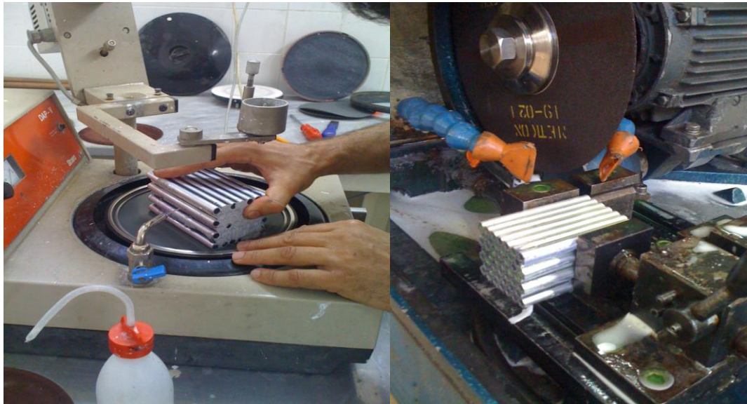
Şekil 3.8. Alüminyum boruların 10 mm kalınlıkta kesme ve yüzey temizliği işlemi
