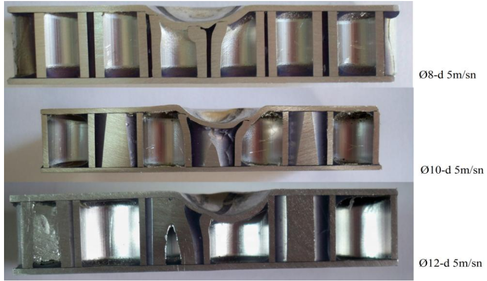
Şekil 4.13. Ø8, Ø10 ve Ø12 mm çapında birim hücreli sandviç kompozitin destekli olarak 5m/s hızında vurucu ile darbe testi sonrası numunenin kesiti
