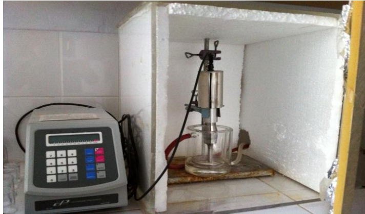
Şekil 3.3. 20 kHz Cole Parmer Instruments ultrases cihazı.
