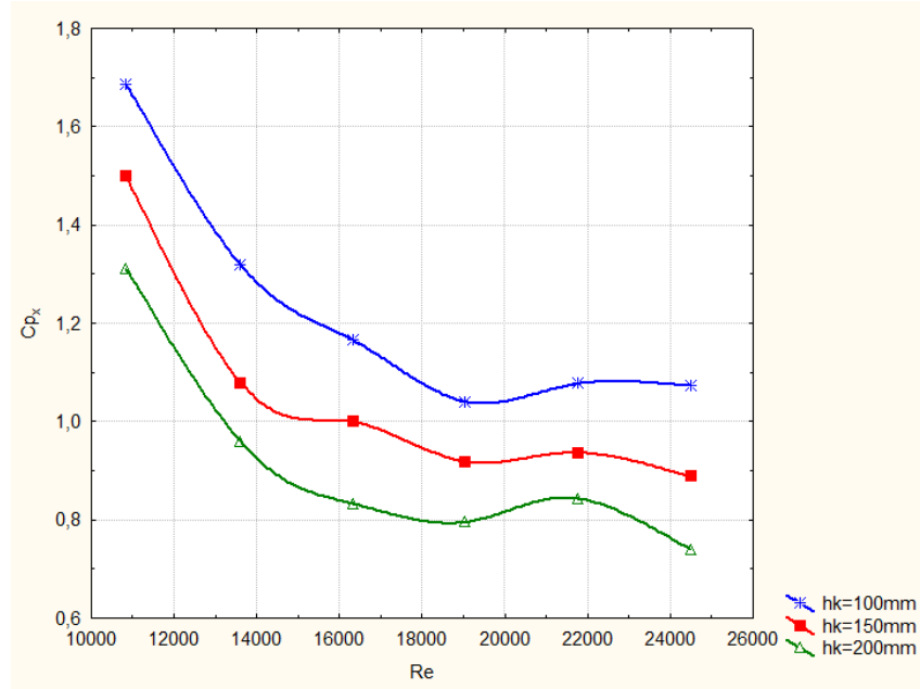
Şekil 4.48. HFG-3 için \Delta P farkının maksimum olduğu istasyonda (4. İst.) C_{p_x} değerlerinin Re sayısı ile değişim grafiği
