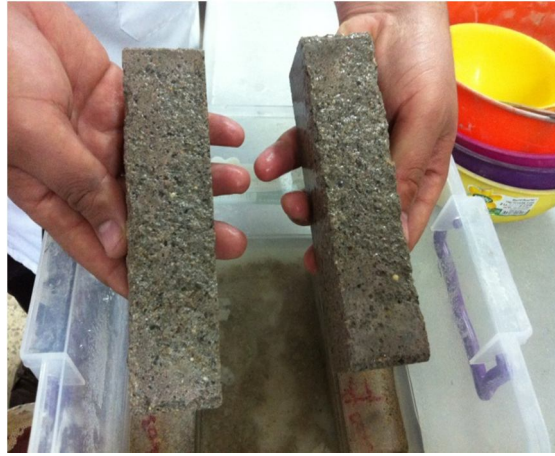
Şekil 2.8. Donma-çözülme deney örnekleri
