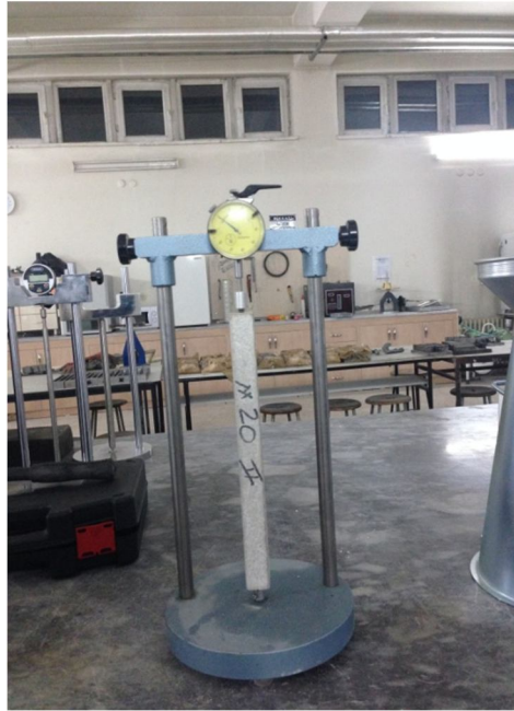
Şekil 2.9. Deformasyon saati ile ölçüm yapılması
