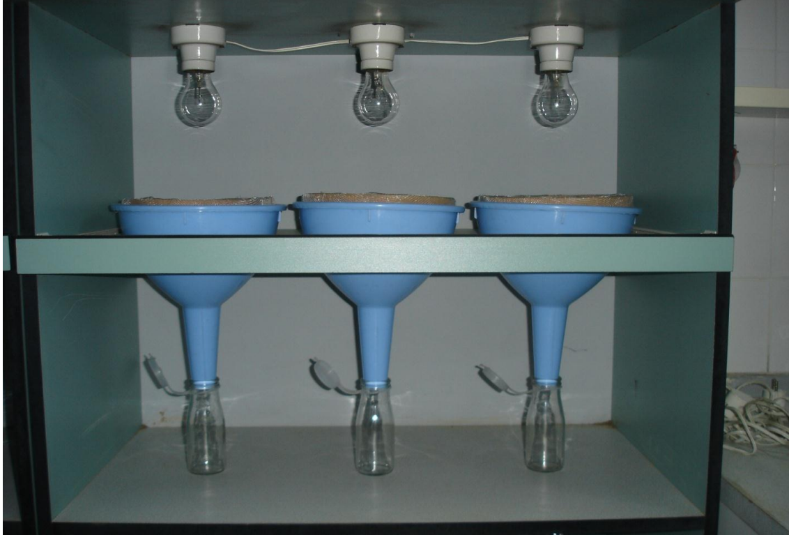
Şekil 2.4. Birleştirilmiş Berlese hunilerinden oluşan toprak akarlarını ayıklama düzeneği.
