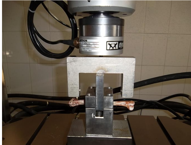
Şekil 3.2. Instron 8872 servohidrolik çeki-bası yorulma ve test cihazı
