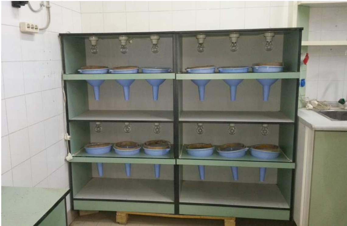
Şekil 2.2. Toprak akarlarını seçme için kullanılan Berlese-Tullgren huni düzeneği.
