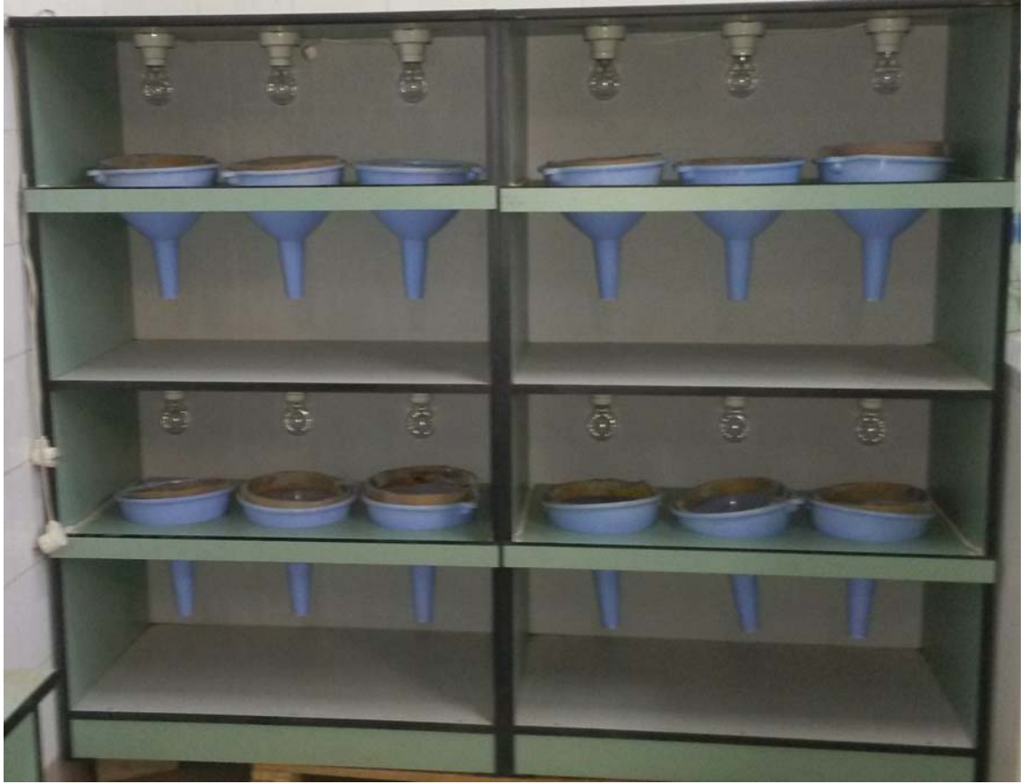
Şekil 2. 2. Toprak akarlarını seçme için kullanılan Berlese-Tullgren huni düzeniği.
