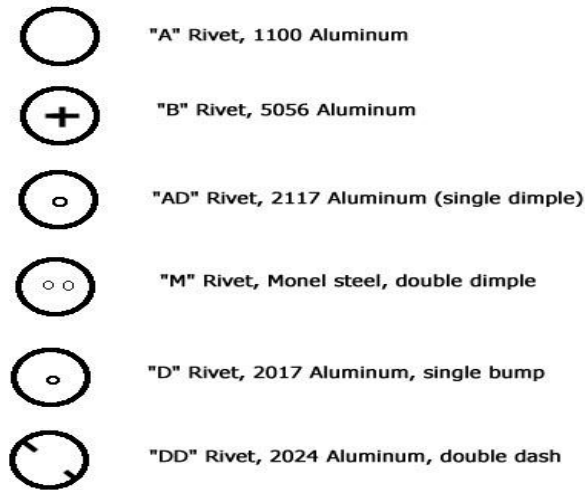
Şekil 4.5. Perçin Başlarındaki Semboller [72]
