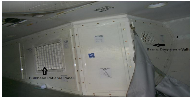
Şekil 3.4. Patlama Paneli ve Basınç Eşitleme Valfi [58]
