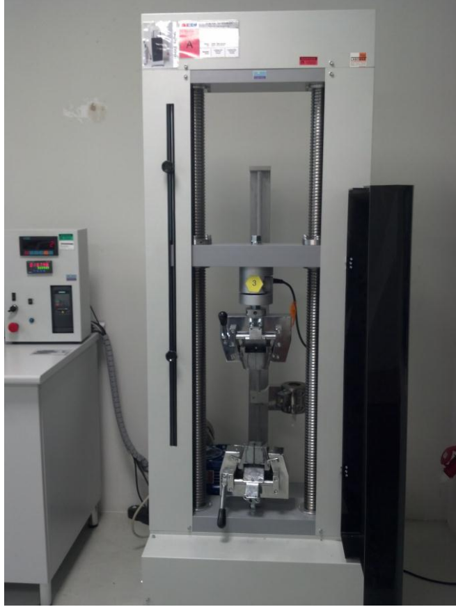
Şekil 5.1. Testlerin Yapıldığı Çekme Test Cihazı
