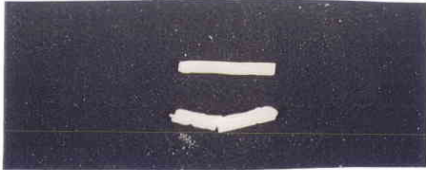
Şekil 3. 5: Çalışmanın ilk aşamasında kullanılmak üzere 3 nokta eğme testi için hazırlanan bir örnek ve test sonrası görünümü
