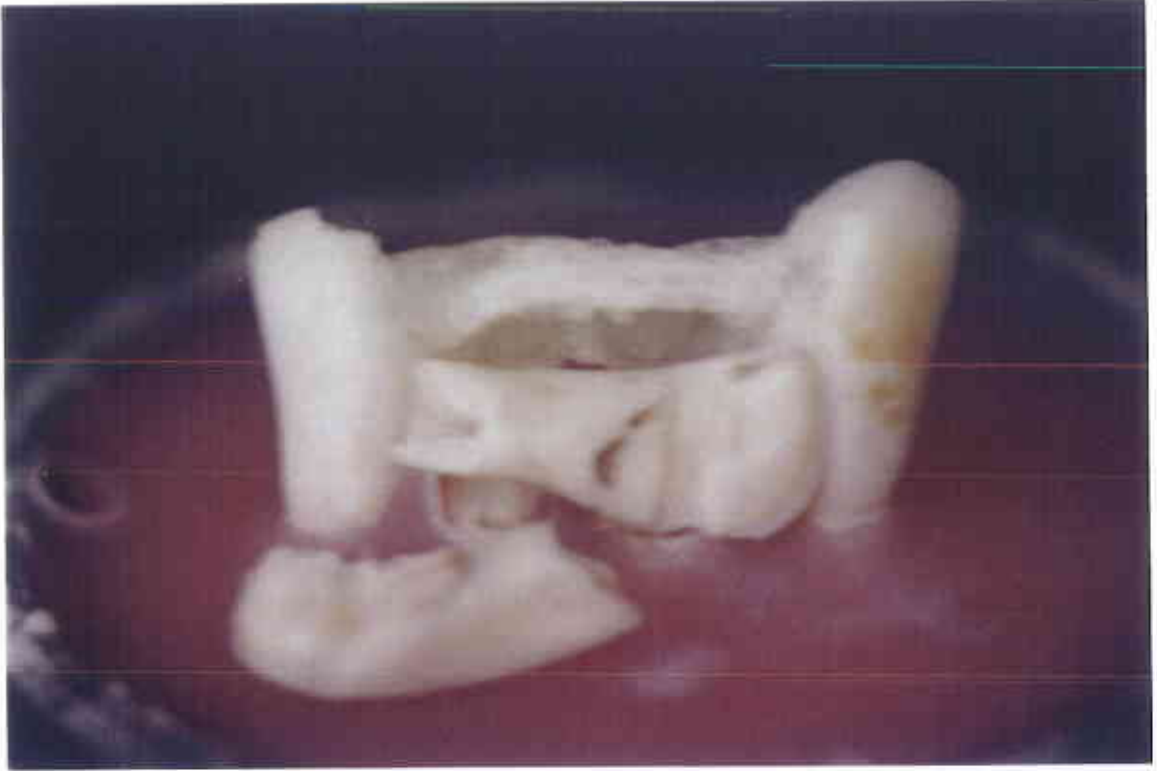
Şekil 4. 8. Ekstrakoronal olarak hazırlanan bir örneğin karakteristik kırılma şekli
