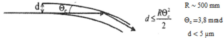
Şekil 2.10. Eğik bir capillary optik
