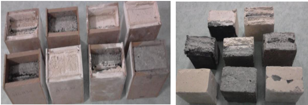
Şekil 3.11.c. 3d'lik numuneler ve kalıptan çıkarıldıktan sonraki görünüşleri
