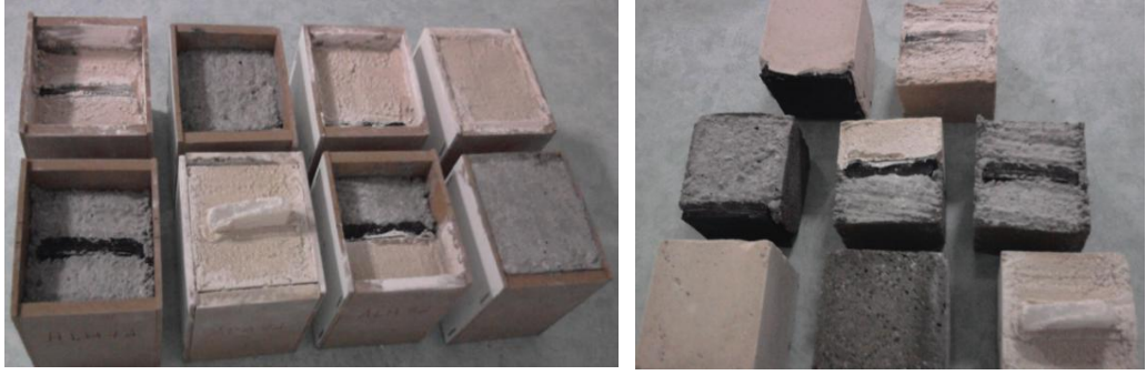
Şekil 3.11.a. 7d'lik numuneler ve kalıptan çıkarıldıktan sonraki görünüşleri
