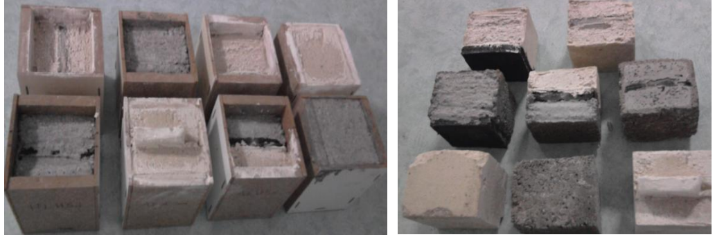
Şekil 3.11.b. 5d'lik numuneler ve kalıptan çıkarıldıktan sonraki görünüşleri
