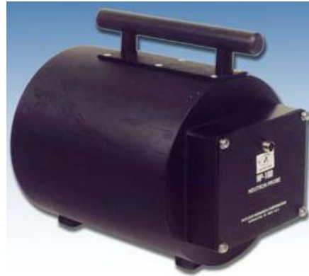
Şekil 3.4. Deneyde kullanılan ADM-606 Model NP serisi nötron dedektörü
