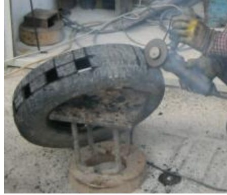
Şekil 3.7. Atık otomobil lastiğinden küçük kesitlerin elde edilmesi
