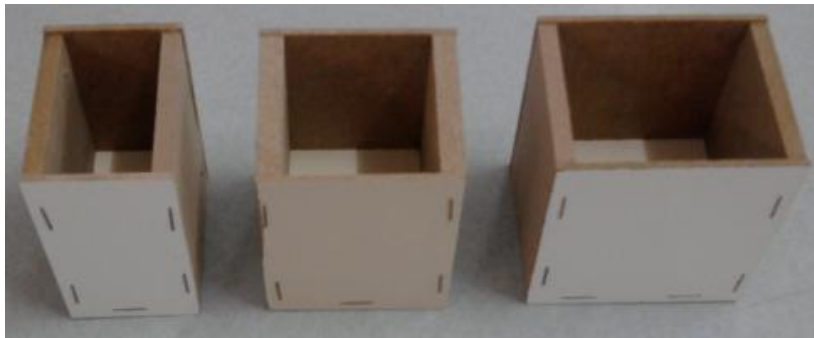
Şekil 3.10. Ahşaptan yapılmış kalıplar
