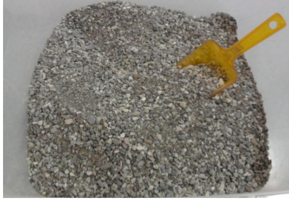
Şekil 3.5. Maksimum agrega çapı 4 mm olan kum
