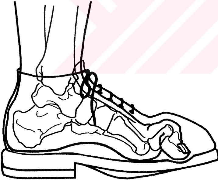
Şekil 2.3.: Tam temaslı iç tabanlı ve erken pivot noktalı rocker barlı bot tipi ayakkabı.
