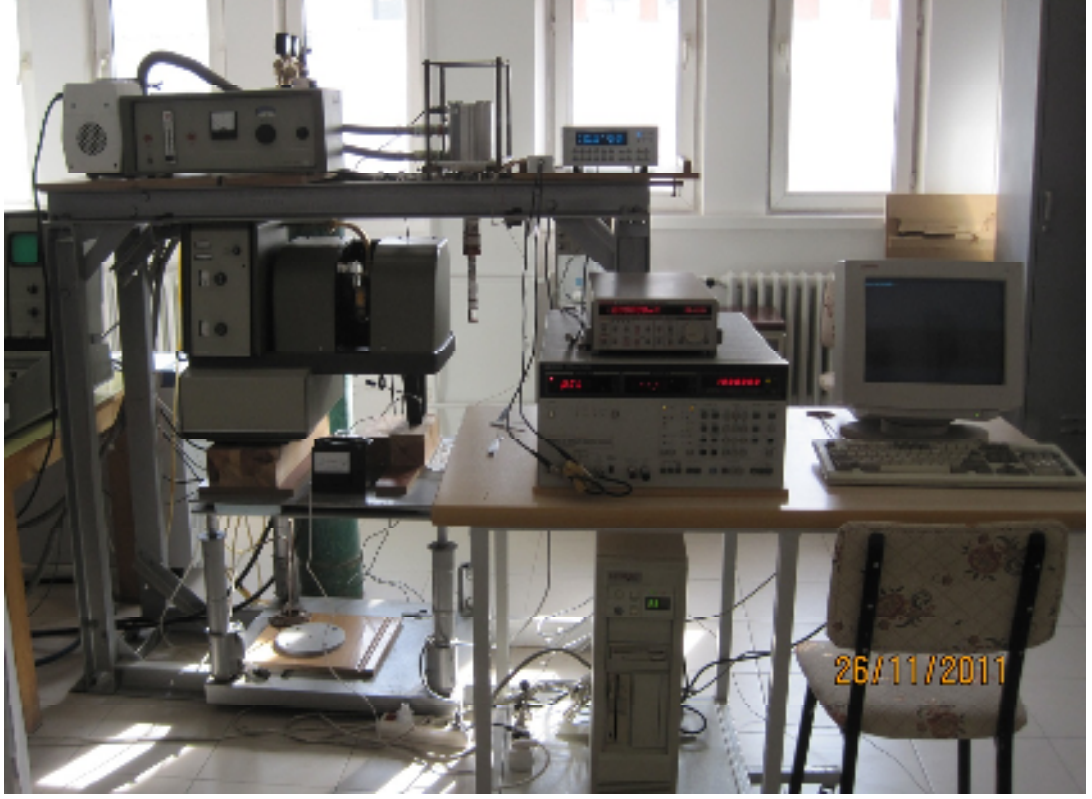
Şekil 3.6. Numunelerin karakterizasyonunda kullanılan bilgisayar kontrolünde çalışan KEITHLEY 487 Picoammeter/Voltage Source ve Lake Shore 331 sıcaklık kontrol ünitesi ile kontrol edilen ARS HC-2 kapalı-döngü helyum kryostatı.
