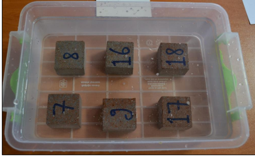
Şekil 3.6. Saf su içerisinde andezit numuneler
