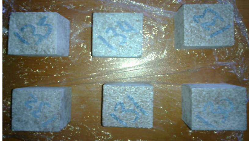
b) Numunelerin başlangıçtaki yüzey görünümleri ( NaCl , 3 çevrim)
