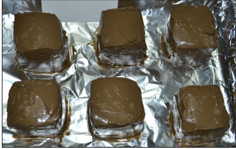
Şekil 3.7. Kil lapasının andezit numuneler üzerine uygulamasının yapılması
