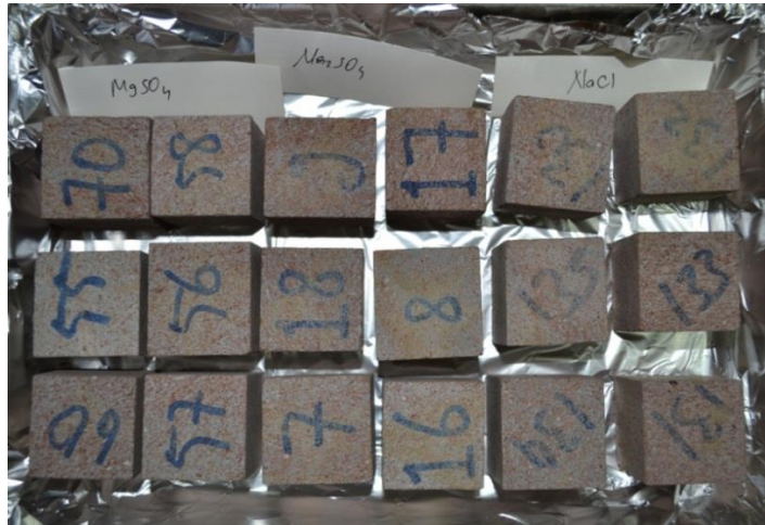
Őekil 4.21. Kil lapaı ile temizleme sonrası yzeylerinden görünümlü (MgSO 4 , NaCl ve Na 2 SO 4 )
