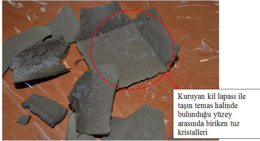
Őekil 4.20. Üçüncü kil lapaı çevrimi sonrası sıyrılan kil lapaı ile tařın temas halinde bulunduęu yzeyi (NaCl)
