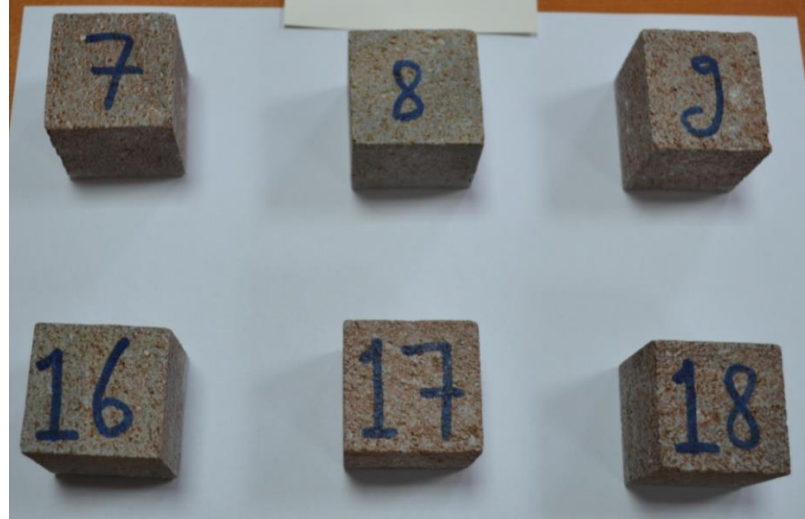
c) Numunelerin başlangıçtaki yüzey görünümleri ( Na_2SO_4 , 3 çevrim)
