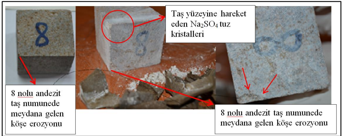
Şekil 4.16. Na 2 SO 4 tuzu ile kirlenilen 8 nolu andezit numunenin birinci kil lapası temizleme çevrimi sonrası köşesinde meydana gelen malzeme kaybı
