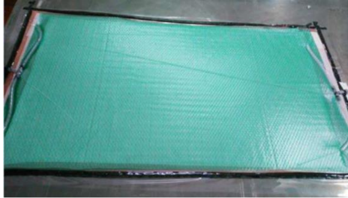
Şekil 3.14. Vakum ortamının oluşturulması.
