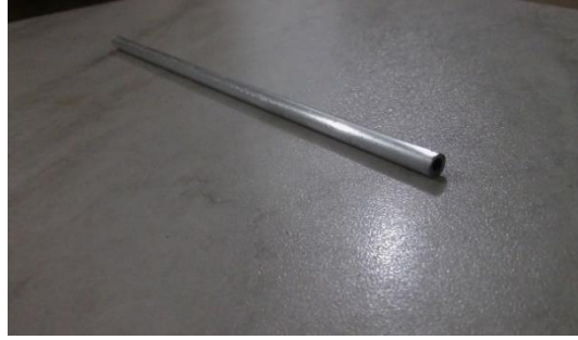
Şekil 3.2. 200 mm uzunluğunda kesilen silindirik Al boru.
