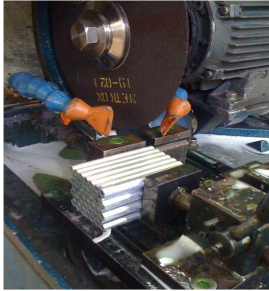
Şekil 3.7. 200 mm kalınlığında üretilen sandviç kompozit çekirdek yapısının daire testerede kesilerek 10 ve 20 mm kalınlığına getirilmesi.
