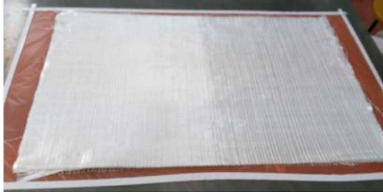
Şekil 3.12. Cam fiber kumaşın ayırıcı film üzerine serilmesi.
