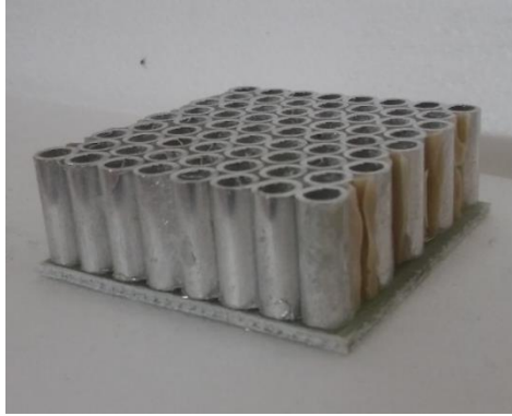
Şekil 3.19. Cam fiberlerin Al çekirdek yapı ile alt-üst plaka olarak birleştirilmesi.
