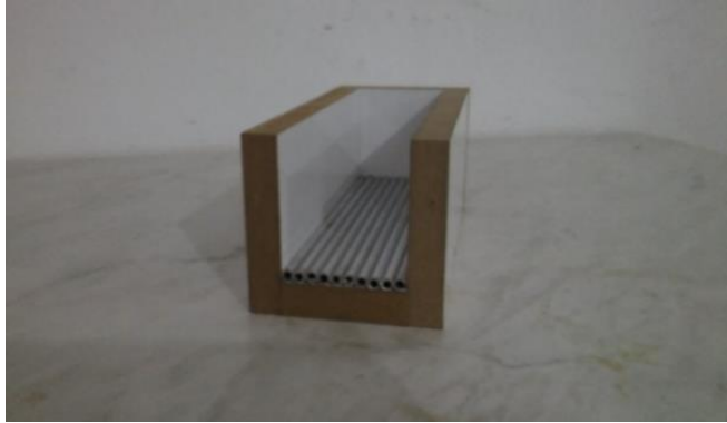
Şekil 3.5. Boruların kalıplara dizilimi ve yapıştırılması.
