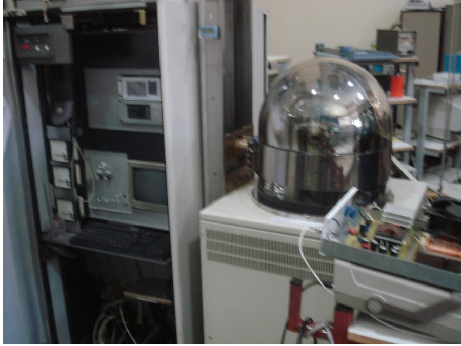
Şekil 3.1. Sputter cihazı (Atatürk Üniversitesi Nanoteknoloji Araştırma Laboratuvarı)
