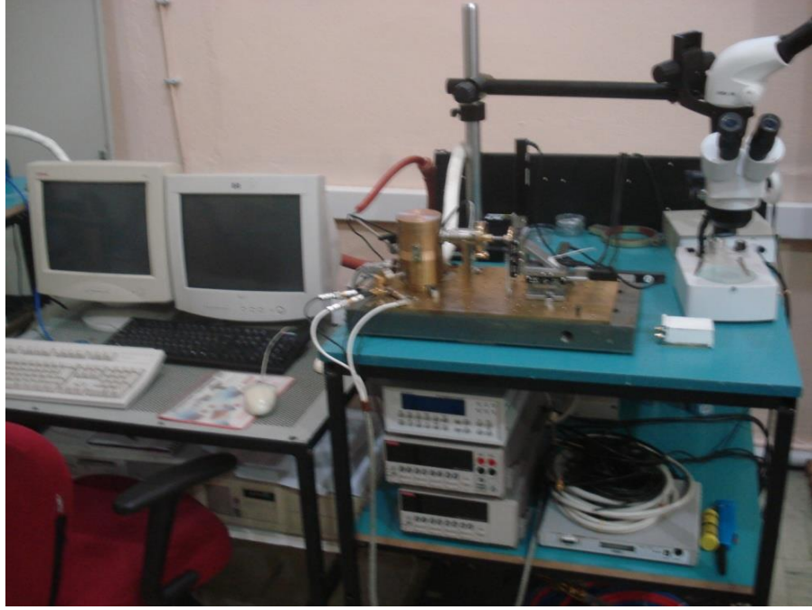
Şekil 3.3. Akım-Gerilim ölçüm ve haritalama sistemi (Atatürk Üniversitesi Nanoteknoloji Araştırma Laboratuvarı)
