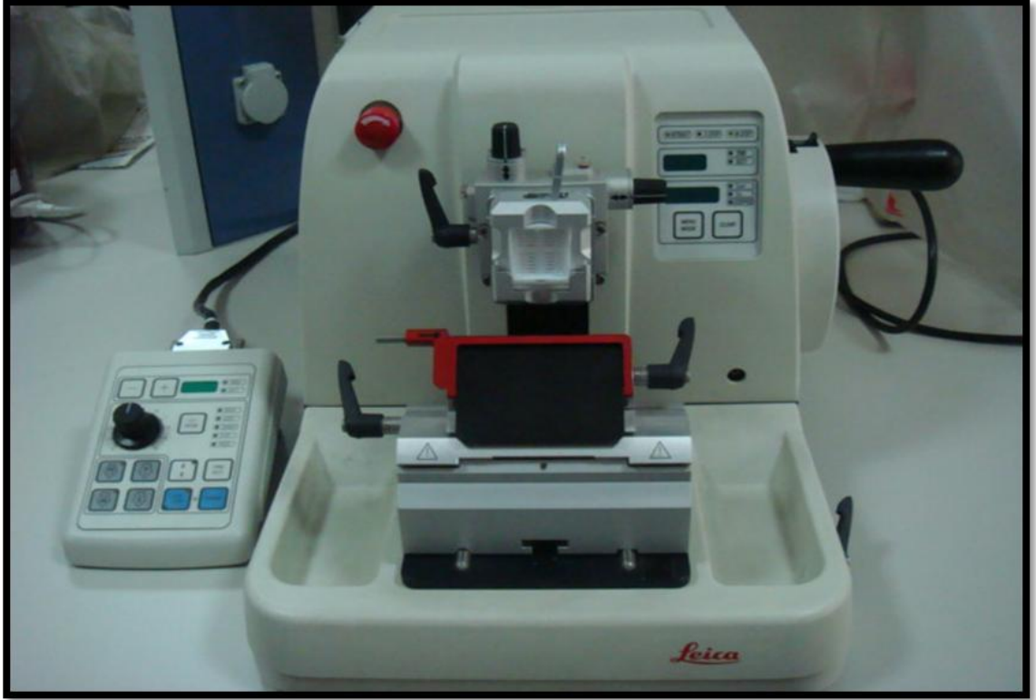
Şekil 3.7. Laboratuvarda kullanılan mikrotom cihazı
