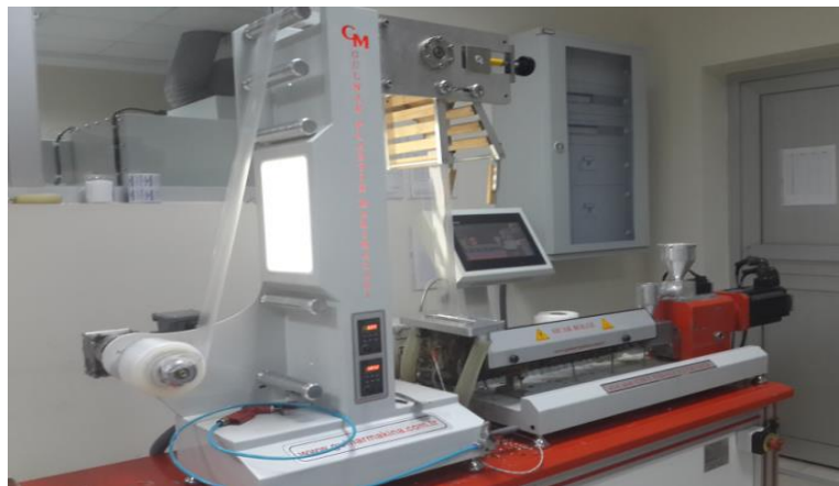
řekil 2.3. PP/HNT Nanokompozitlerin Hazırlanmasında Kullanılan ift Burgulu Ekstrüder.
