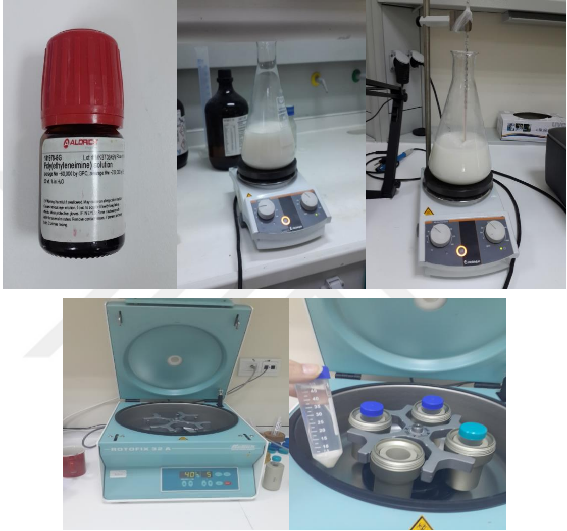
Şekil 2.1. PEI Yüzey modifikasyonu (SM-1) işlem basamakları
