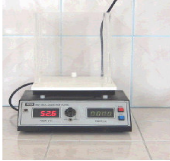
Resim 2: Nosiseptif ölçümlerin alındığı termal ağrı ölçer Hot-plate cihazı
