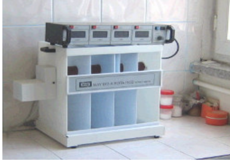
Resim 1: Lokomotor aktivitenin ölçüldüğü Rota-rod cihazı
