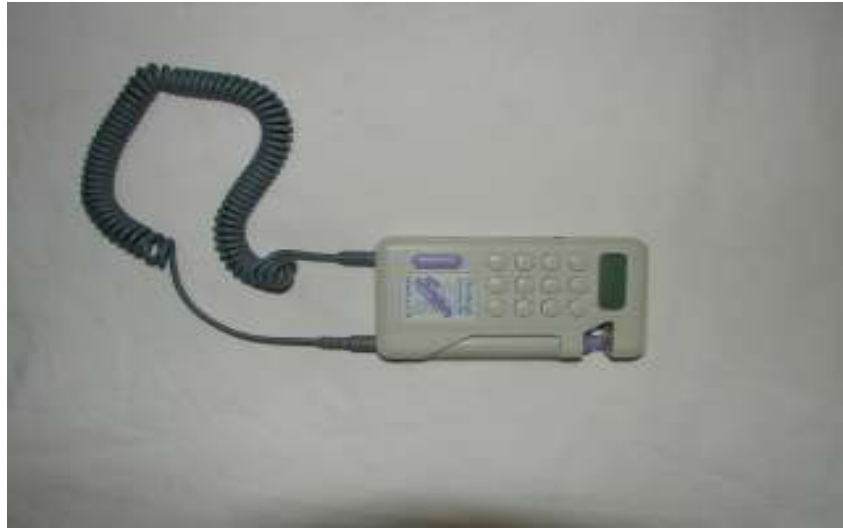
Şekil-5. ABİ hesaplamasında kullanılan el dopler cihazı
