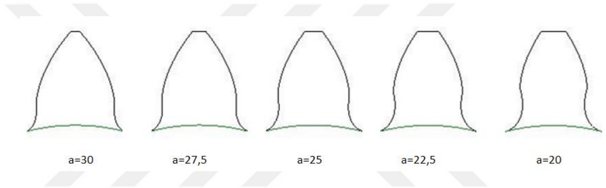
Şekil 5. 2,75 mm modül değeri için 20^\circ - 22,5^\circ - 25^\circ - 27,5^\circ - 30^\circ basınç açılarındaki dişli profilleri
