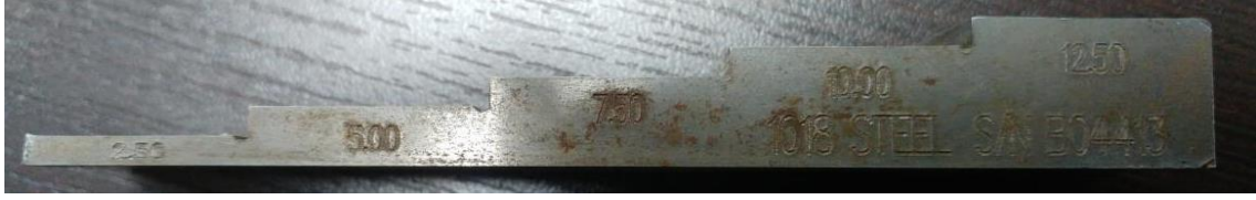
Şekil 3.2: Çelik (1018) kalibrasyon bloğu
