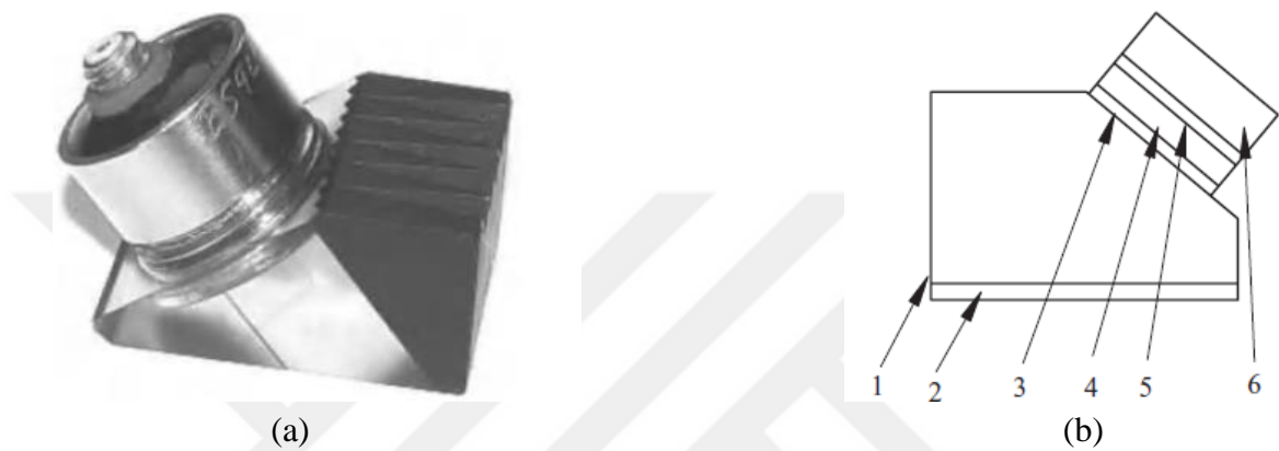
Şekil 1.11: Açılı prob ve iç yapısı: (a) Prob görünümü, (b) Probun iç yapısı. 1) Takoz, 2) Eşleşme katmanı (takoz-malzeme), 3) Eşleşme katmanı (takoz-kristal), 4) Kristal, 5) Eşleşme katmanı (kristal-sönümleme katmanı), 6) Sönümleme katmanı [1]
