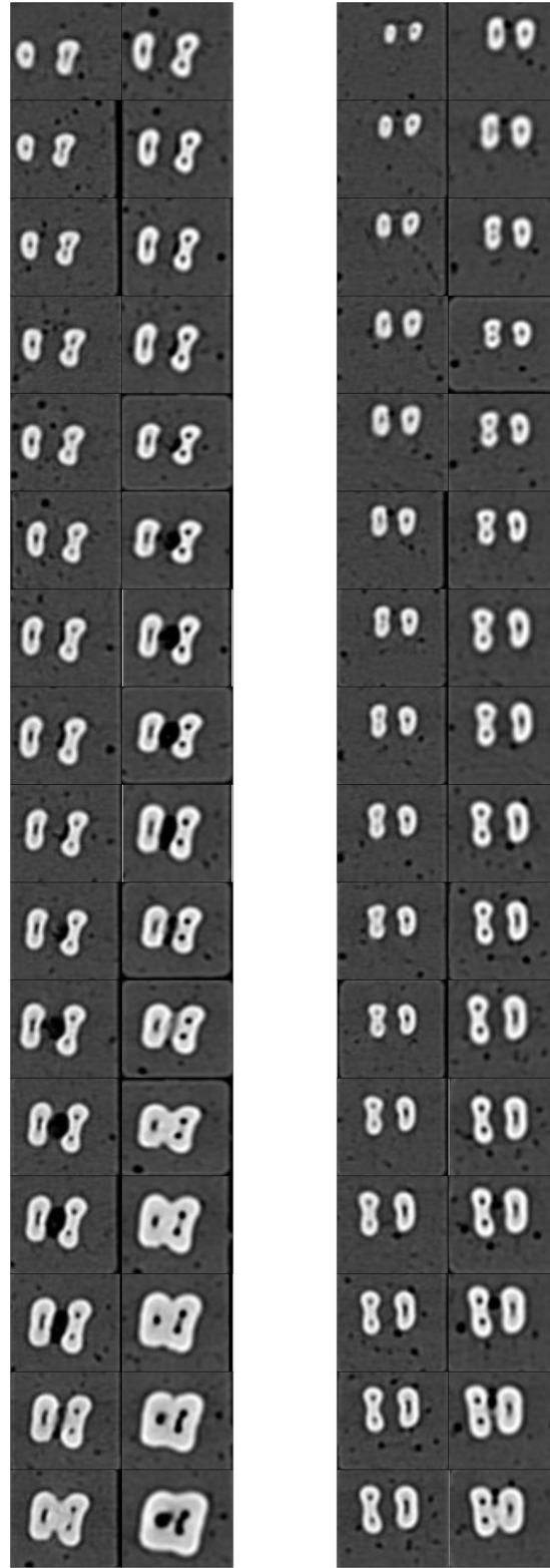
Resim. 4.2. Şekillendirme öncesi ve sonrası kesitlerin bilgisayar tomografi görüntüleri
