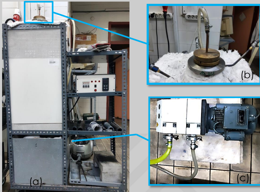
Şekil 3.3. Vakumlu ergitme fırını a) fotoğrafı, b) üst kapak, c) vakum pompasının dış görünüşü.
