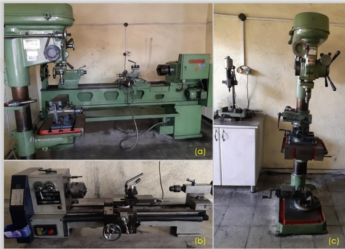
Şekil 3.22. Laboratuvarımız bünyesinde bulunan torna atölyesinin görüntüleri a) Büyük torna, b) Küçük torna c) Eğimli matkap (solda), düşey sütunlu matkap (sağda).
