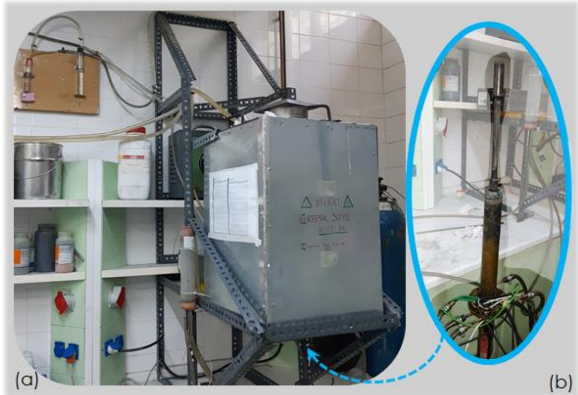
Şekil 3.15. a) Doğrusal katılaştırma fırını ana gövdesi b) soğutucu ve sürücü sistemlerin dış görünüşü.
