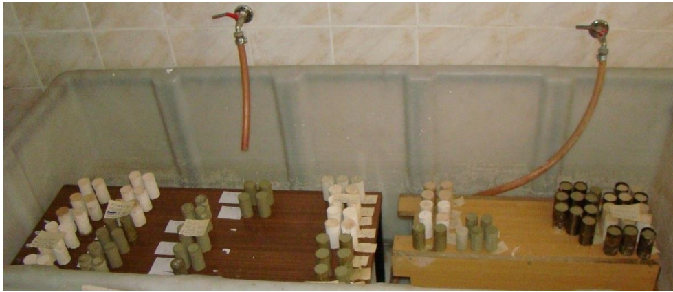
Şekil 3.13. Biyopolimer katkılı CL ve CH kilininin polyester deneylerinin kür odasında bekletilmesi
