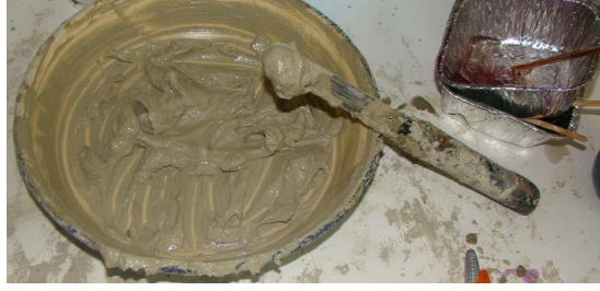
Şekil 3.9. CH Kili-polyester karışımının hazırlanması
