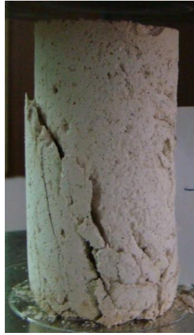
Şekil 4.19. CL kili-polyester-biopolimer numunesinin kırılması
