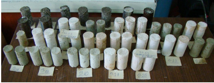
Şekil 3.14. Kür odasında bekletilen KG katkılı CL ve CH kili-polyester numuneleri
