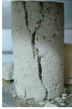
Şekil 4.22. CH kili-polyester-biyopolimer numunesinin kırılması
