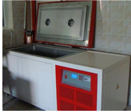
Şekil 3.17. Donma-çözülme cihazında bekletilen alüminyum folyo içerisindeki numuneler
