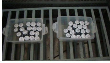
Şekil 3.17. Donma-çözülme cihazında bekletilen alüminyum folyo içerisindeki numuneler
