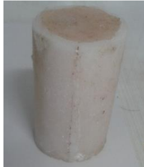
Şekil 4.4. Su içerisinde hazırlanan polyester numunesi
