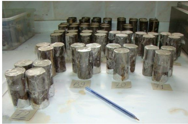
Şekil 3.11. CL ve CH kili-polyester numunelerinin kapalı olarak bekletilmesi
