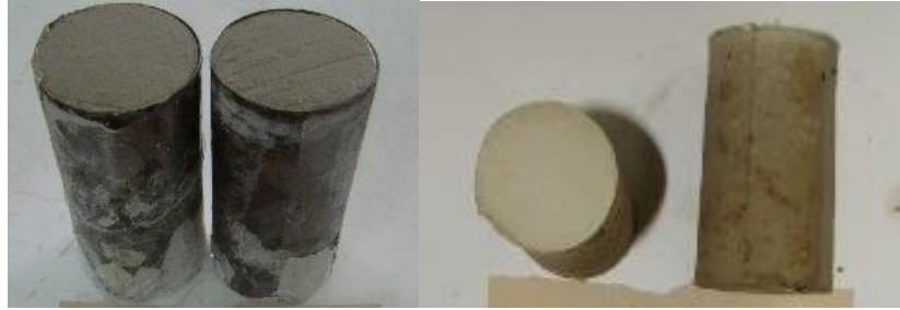
Şekil 3.10. CH kili-polyester numunesinin kalıba konulması ve kalıptan çıkarılmış hali
