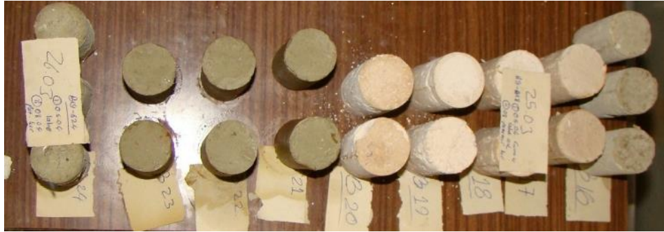
Şekil 3.15. Kür odasında bekletilen biyopolimer ve kireç katkılı CL ve CH kili-polyester numuneleri
