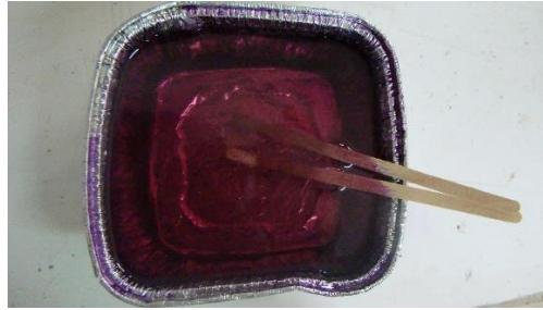
Şekil 3.4. Alüminyum folyo kapta hazırlanmış polyester karışımı
