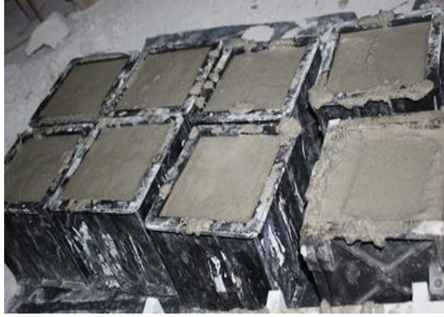
Şekil 3.7. Gaz beton örneklerin kalıplara dökümü
