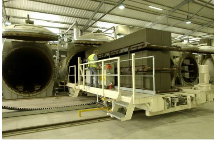
Şekil 2.19. Gaz beton buhar kürü (otoklav) makinesi (Anonymous 2012f)
