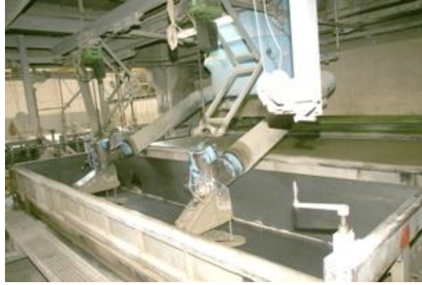
Şekil 2.17. Gaz beton döküm arabası (Anonymous 2012e)
