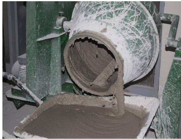
Şekil 3.6. Gaz beton örneklerin karışımı ve arabaya aktarımı
