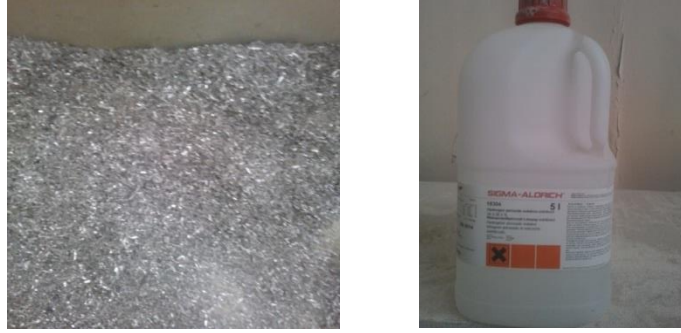
Şekil 3.4. Kabarma sağlayıcı katkı maddeleri (alüminyum tozu ve hidrojen peroksit)
