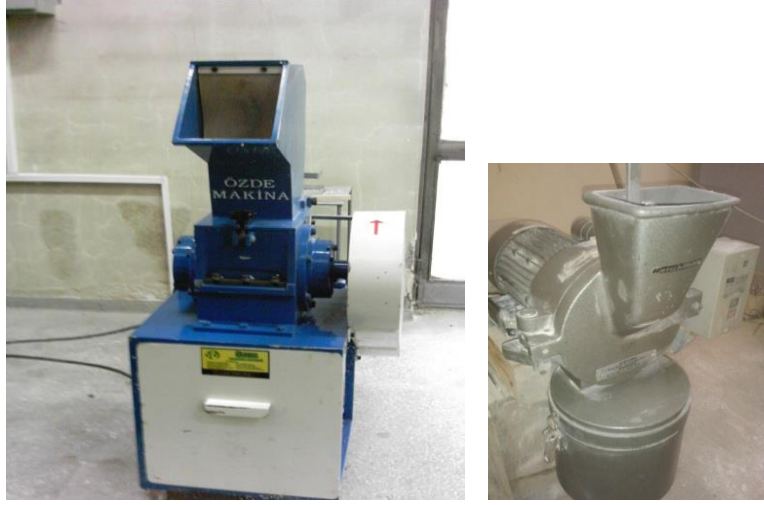
Şekil 3.3. Alüminyumun parçalanmasında kullanılan kırma makinesi ve değirmen
