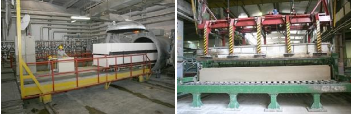
Şekil 2.18. Gaz betonların üretim sürecinde buhar kürü ve kesim vinci (Anonymous 2012e)
