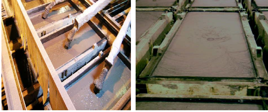
Şekil 2.16. Gaz beton üretiminde sulu harcın kalıba dökülmesi ve kabarma süreci (Anonymous 2012f)
