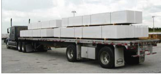
Şekil 2.21. Gaz betonun taşıma süreci
