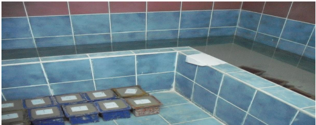
Şekil 4.4. Beton kür odası
