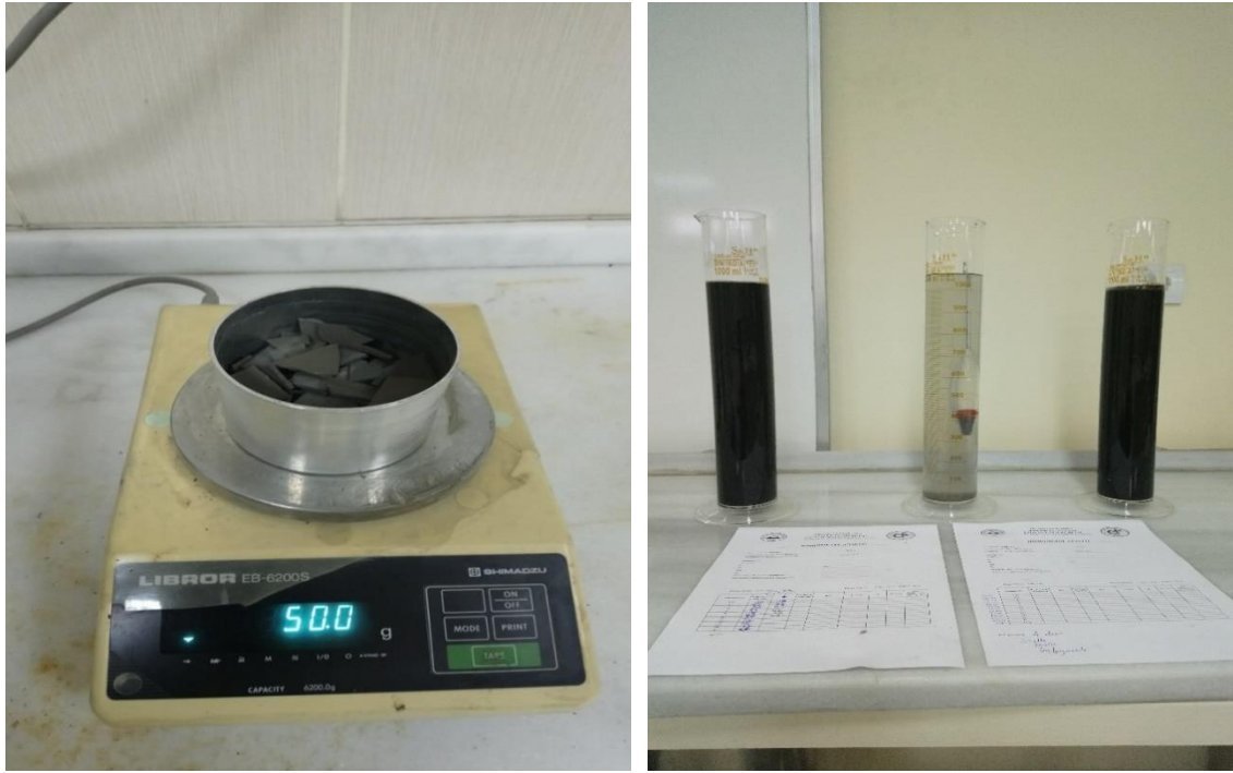
Şekil 3.12. Hidrometre deneyi numunesi ve hidrometre mezürleri
