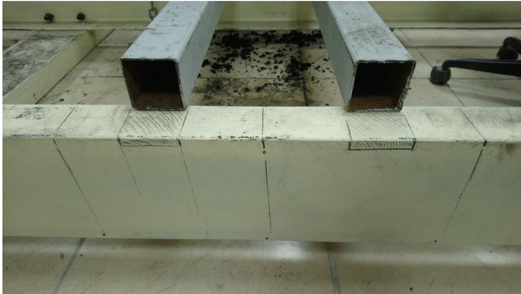
Şekil 4.2. Deney kasalarının kutu profiller ile yerlerinin tespiti
