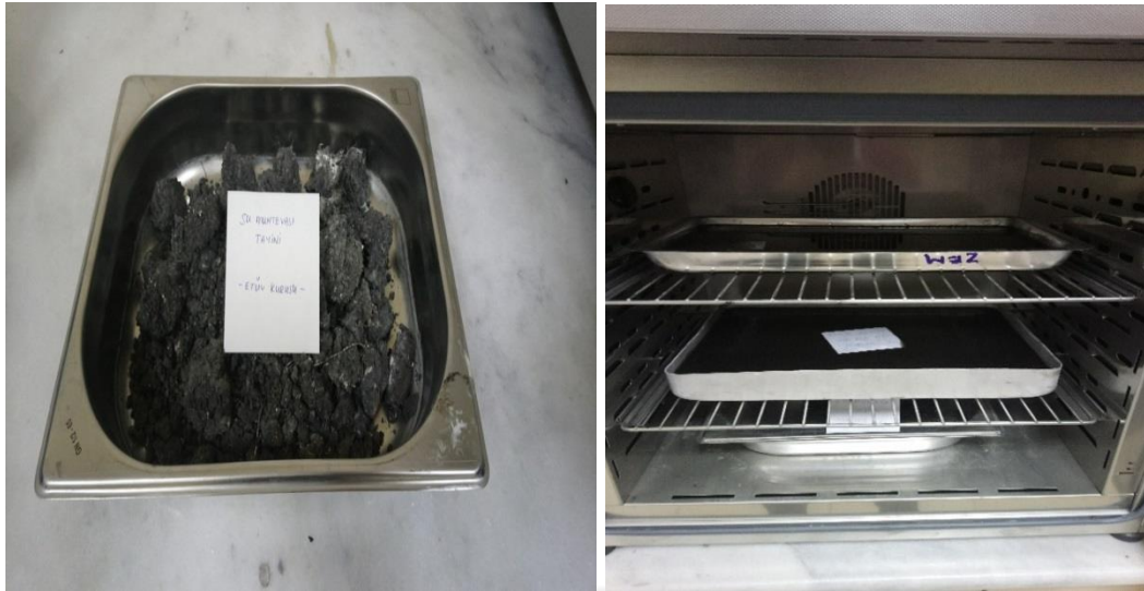
Şekil 3.11. Su muhtevası tayini için etüvde kurutulan numune örnekleri
