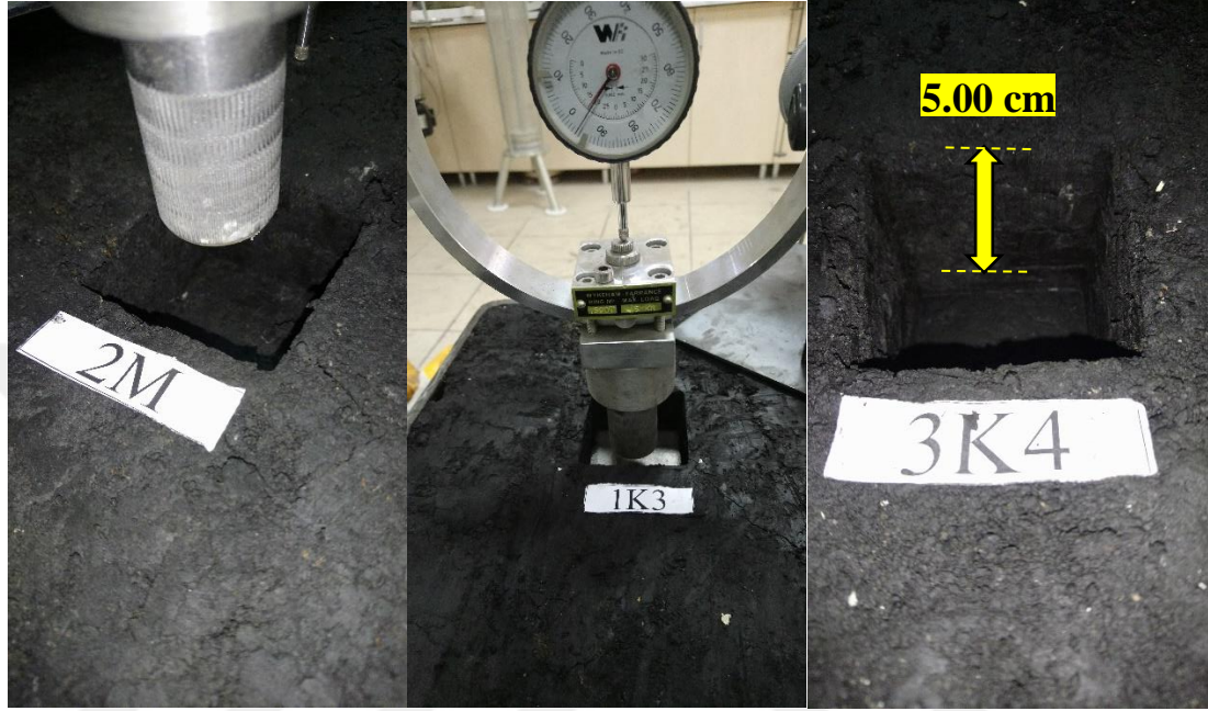
Şekil 4.4. Yükleme sonrası göçme yüzeylerinin gözlemlenmesi
