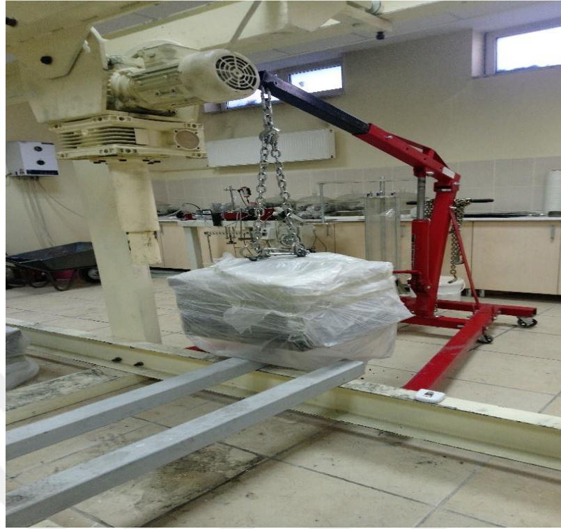
Şekil 4.3. Deney kasalarının yükleme çerçevesine yerleştirilmesi
