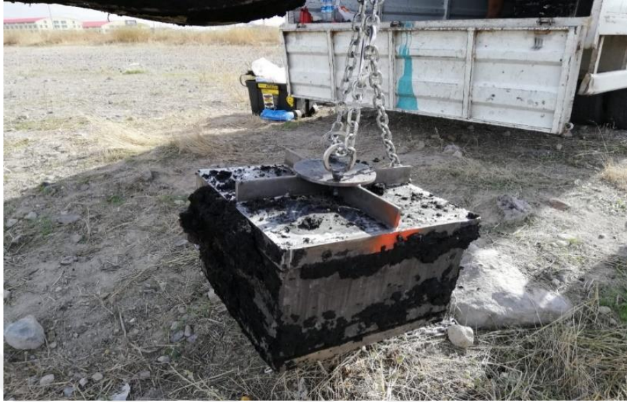
Şekil 3.9. Numune kasalarının zemin içerisinden çıkarılması
