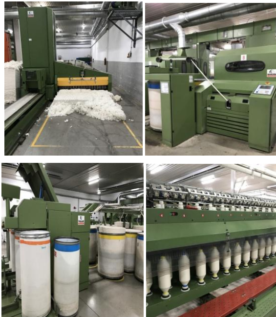
Şekil 2.2.Harman hallaç, tarak, cer ve fital makinası
