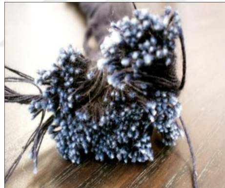
Şekil 1.15.İndigo boyalı çözümlü ipliğinde "ring dyeing" özelliğinin pH ile değişimi [36]
