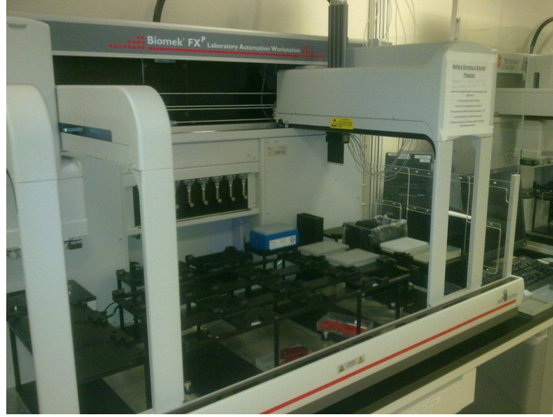
Şekil 3.3. OpenArray AutoLoader (Beckman Biomek FX P, Laboratory Automation Workstation). Örnek pleytinden, genotipleme çiplerine aktarım sağlanır.
