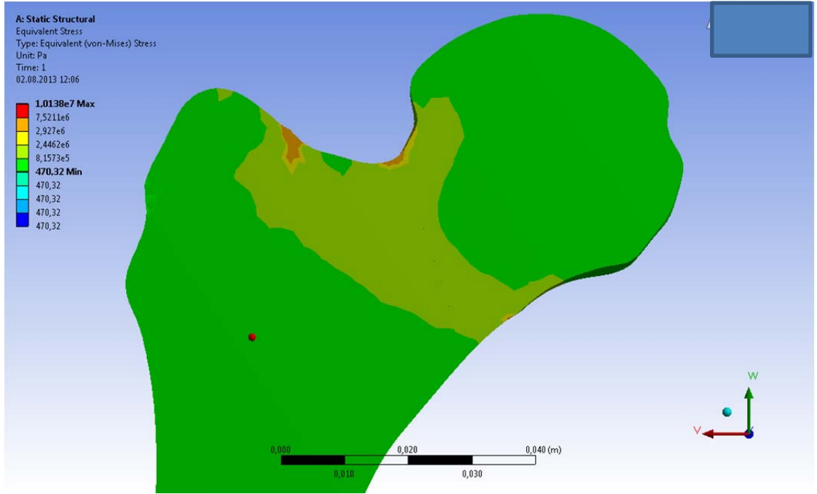
Şekil 5.12. \sigma_M ( von-Mises ) gerilmelerinin kesit görünüşü
