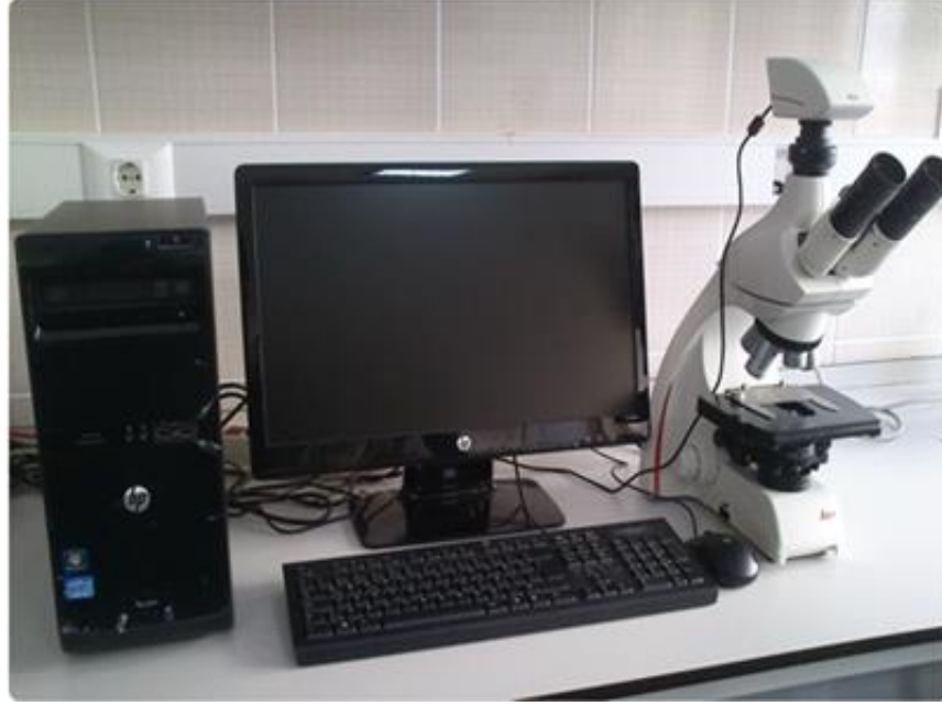
Şekil 3.4. Kamera ataçmanlı ışık mikroskobu
