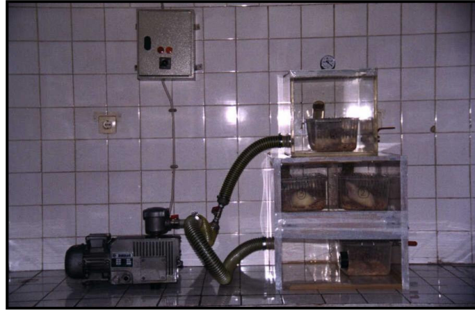
Şekil 3. Kronik hipoksi uygulamak için kullanılan sistem: Kronik hipoksi (altta) ve aklimatizasyon (üstte) kafesleri.
