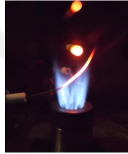
Şekil 4. 14. H_2/CO:1.0 sentetik gazlarının alev görüntüleri.
