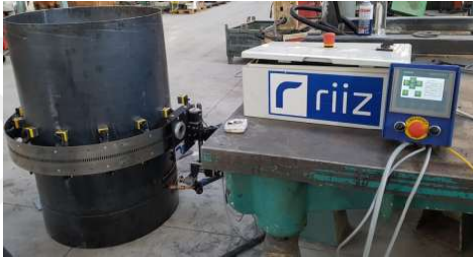
Şekil 46 - Dikey boruya bağlanmış kaynak traktörü
