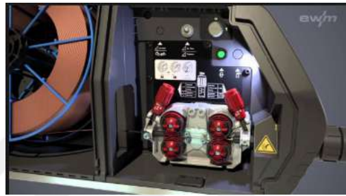
Şekil 4- Tel besleme ünitesi (EWM marka)
