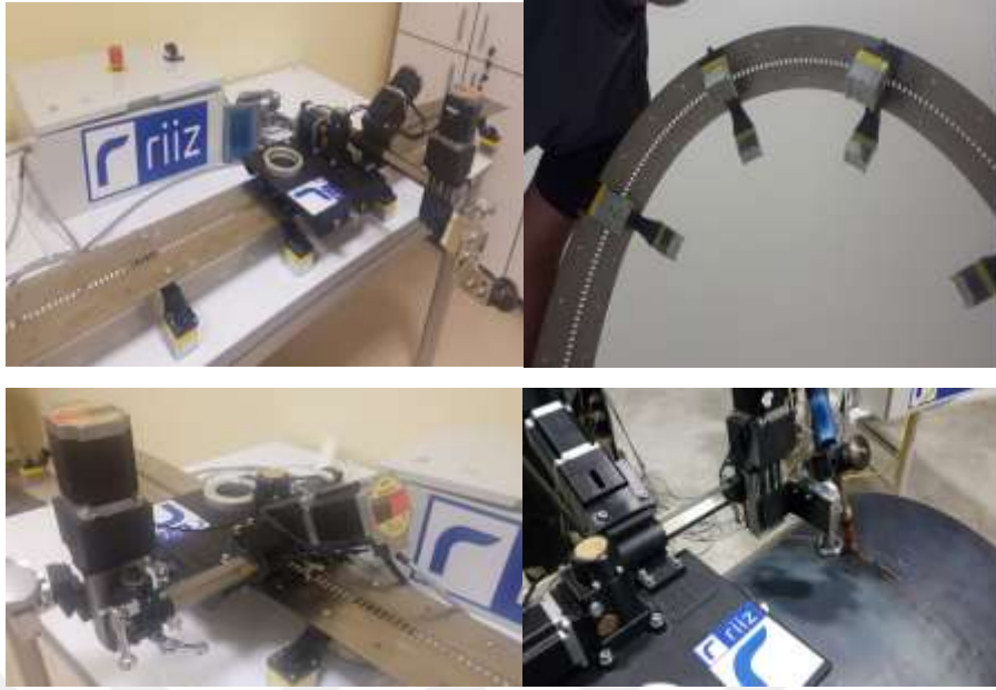
Şekil 41 - Traktörün düz zeminde duruşu ve rayın esnemesinin incelenmesi
