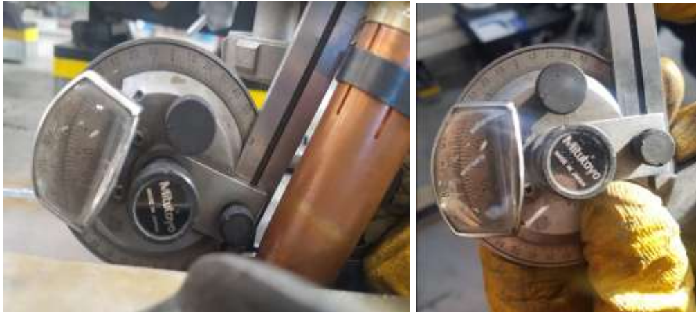
Şekil 44 - Kaynak esnasında ideal torç açılarını belirlemek için yapılan çalışmalar
