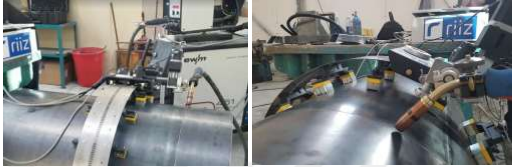
Şekil 43 - Kaynak Traktörünün X52 borusu üzerine yerleşimi
