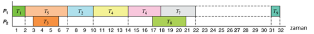
Şekil 4.13. Şekil 4.10’deki DAG’dan elde edilmiş Gantt grafiği (Hwang et al. 2008)
