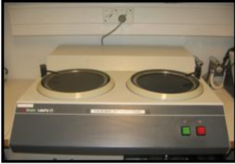
Şekil 3.1.1. Dişlerin kronlarının aşındırılmasında kullanılan otomatik aşındırma cihazı.
