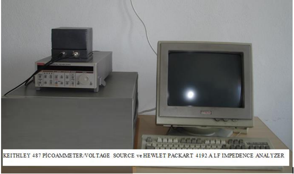
Şekil 3.9. Akım-Gerilim ölçüm sistemi
