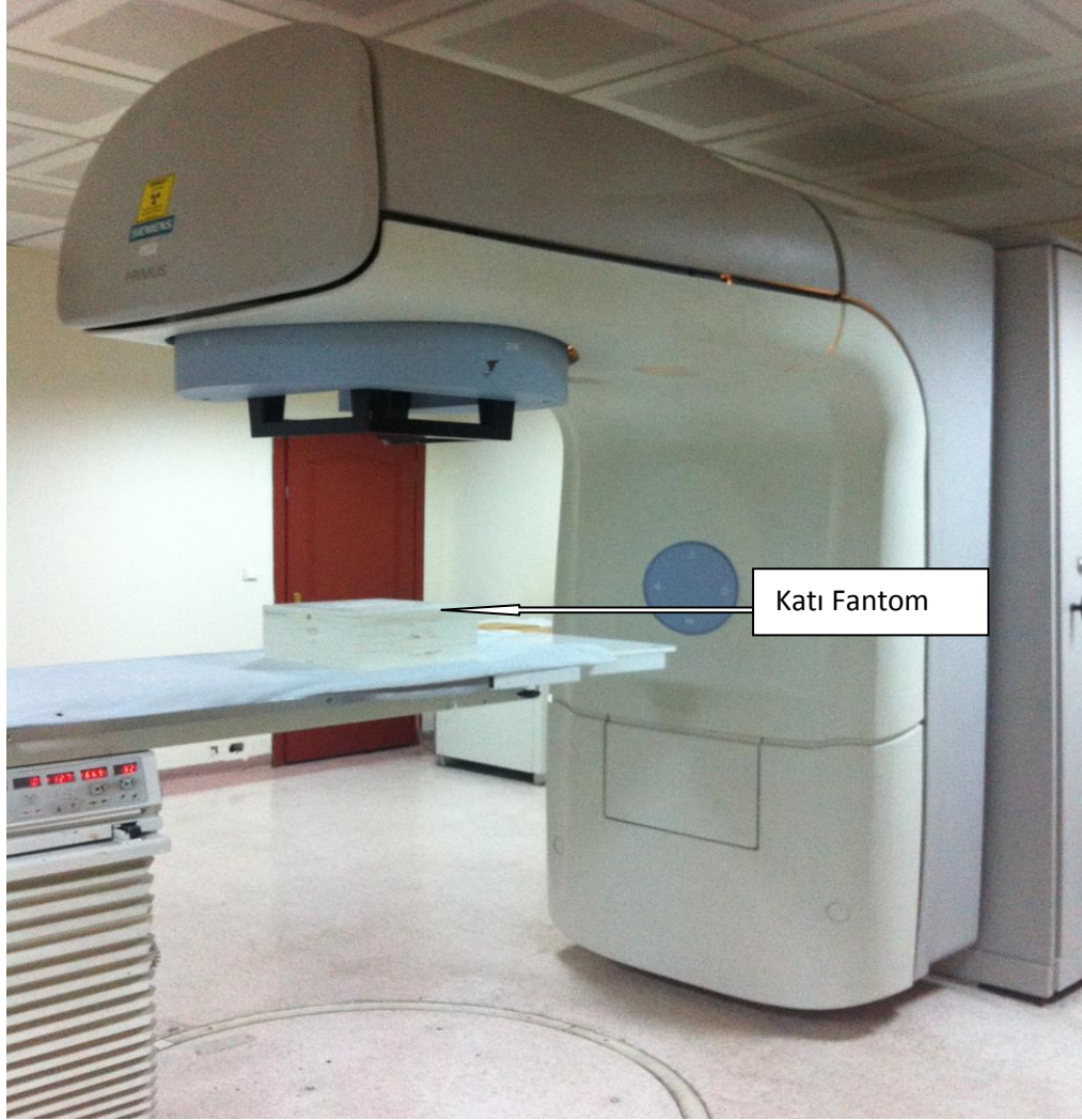
Şekil 3.7. Lineer Hızlandırıcı ve Işınlama düzeneği
