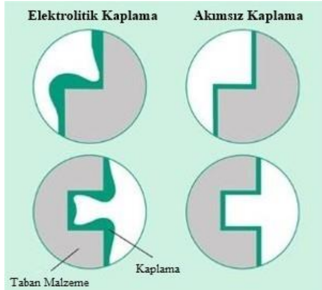
Şekil 2.3. Elektrolitik kaplama ve akımsız kaplama işlemleri ile yapılan kaplamaların şematik resmi (Anonymous 2014).
