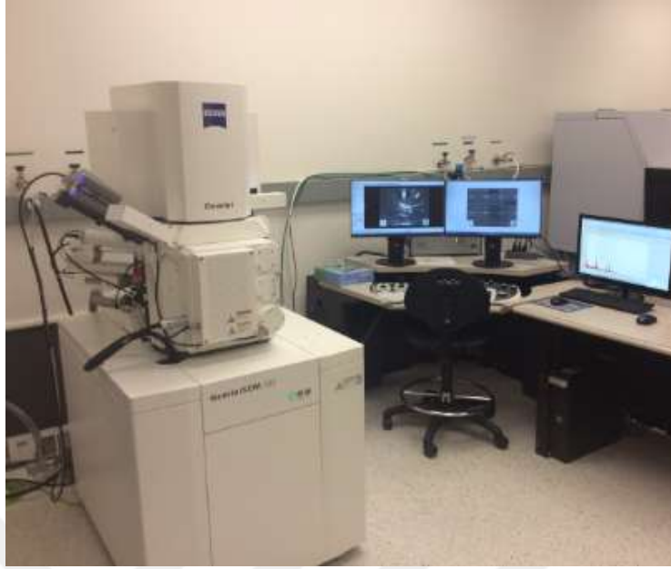
Şekil 2.15. Analizlerde kullanılan EDS eklenmiş taramalı elektron mikroskobu
