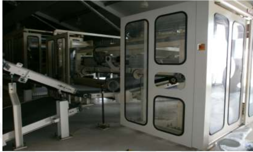
Şekil 2.3. Çalışmada kullanılan çapraz serici
