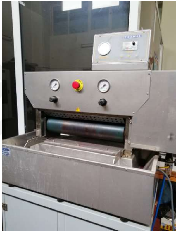
Şekil 2.6. Çalışmada emdirme metodu için kullanılan laboratuvar tipi fulard
