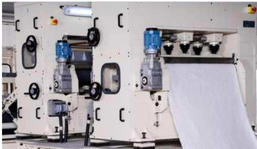
Şekil 2.4. Çalışmada kullanılan ön iğneleme ve esas iğneleme tezgahları
