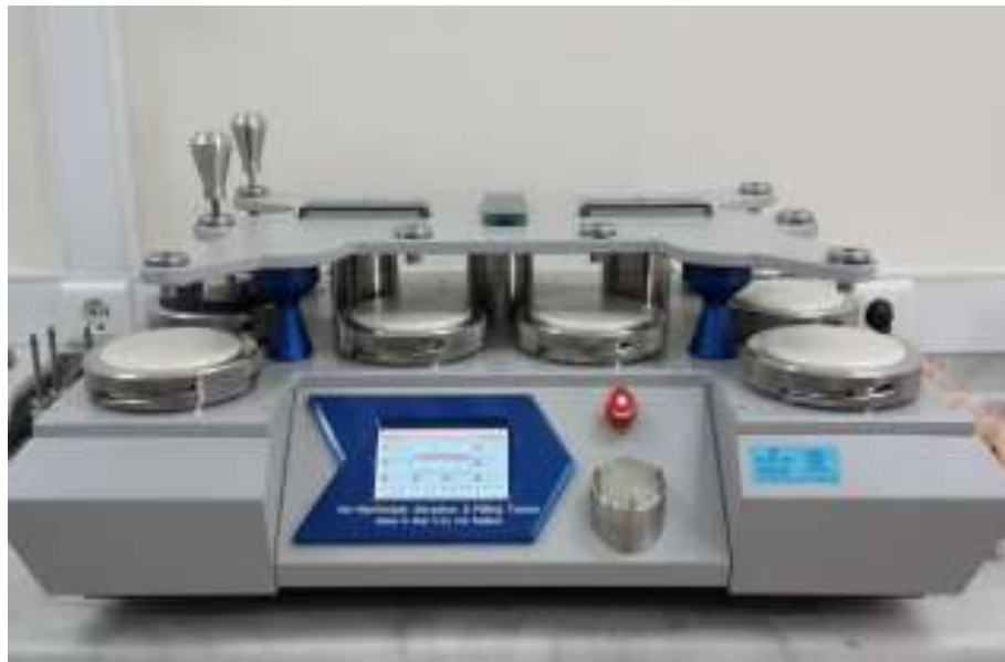
Şekil 2.12. James H. Heal Nu-Martindale aşınma ve pilling cihazı
